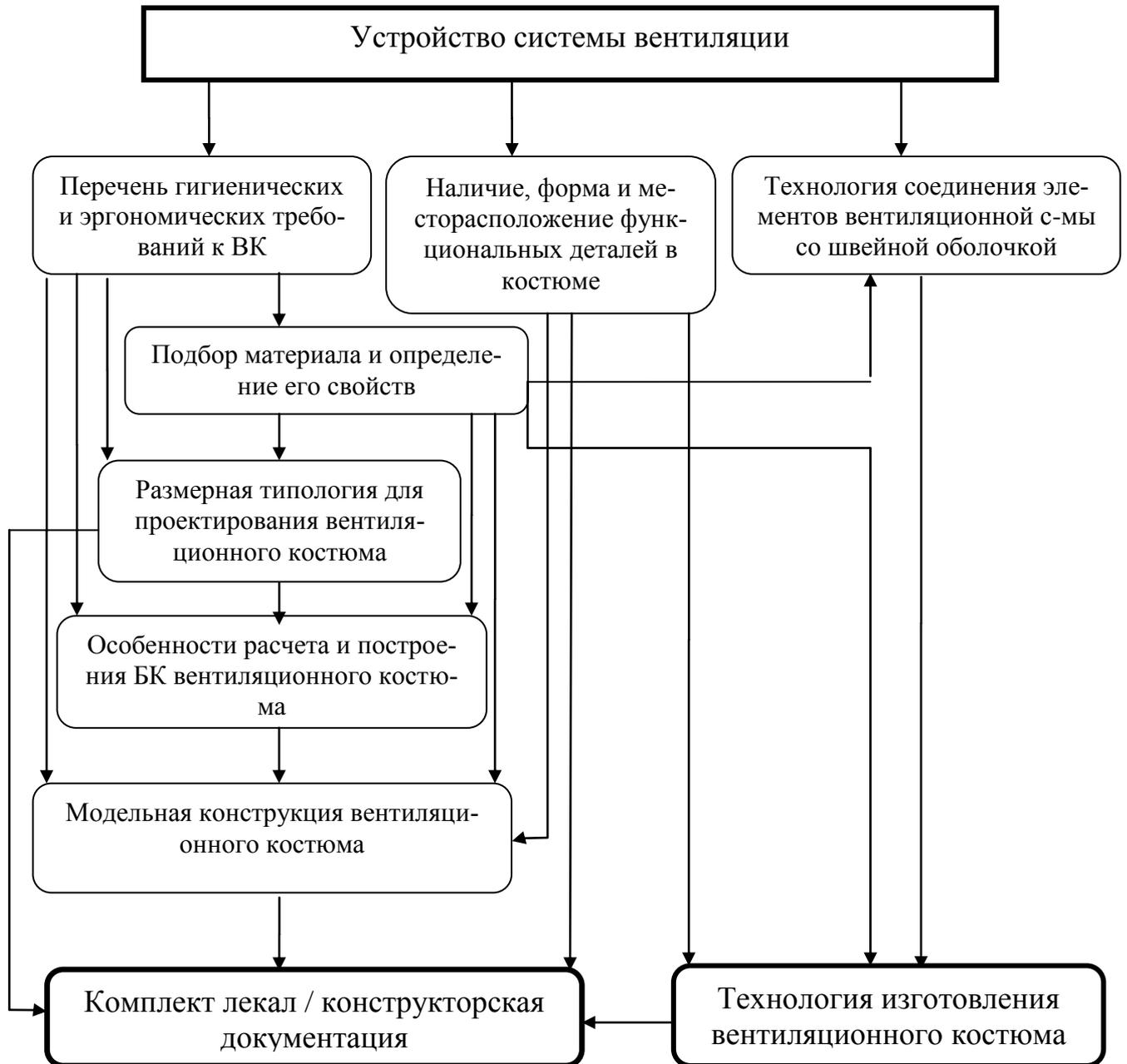
Рисунок 28 – Последовательность проектирования ВК с учетом параметров системы вентиляции
