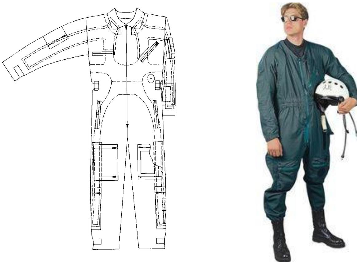
Рисунок 6 – Вентиляционный костюм ВК-3М: на схеме пунктирными линиями отмечено месторасположение системы вентиляции [18,19]
