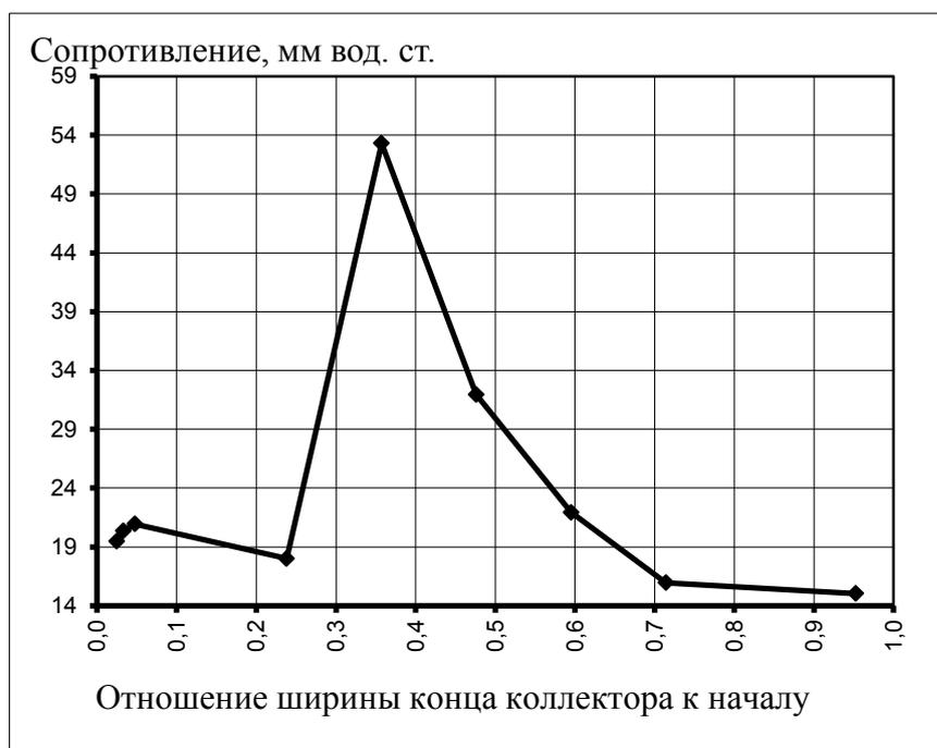
Рисунок Г3 – График соотношения формы коллектора к его сопротивлению
